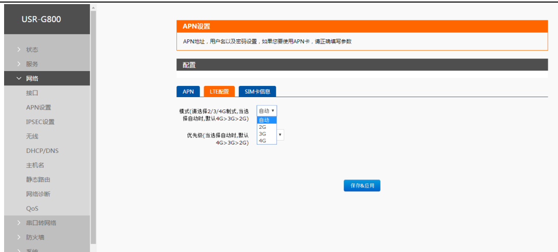
图 60 图 29 LTE 设置页面
