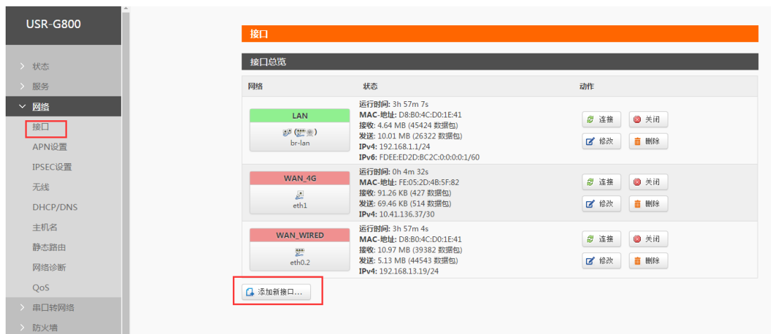
图 71 路由器添加 VPN 操作图一
