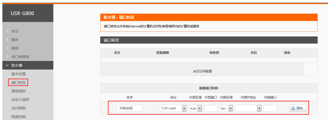
图 134 端口转发设置页面一
