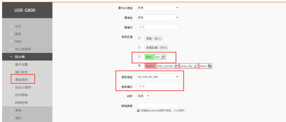
图 122 防火墙黑名单图三
