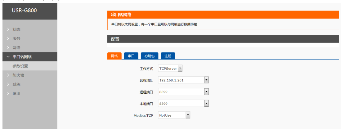
图 149 串口转网络界面
