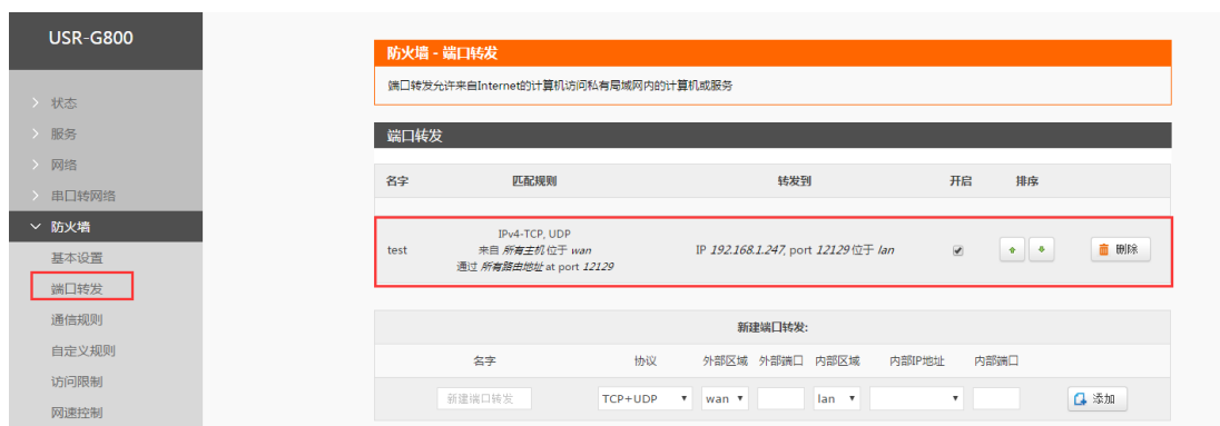
图 137 4G 网络端口映射二
