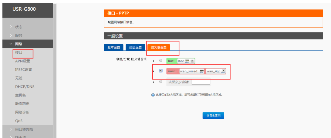
图 73 路由器添加 VPN 操作图三
