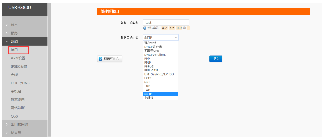
图 102 SSTP VPN 接口创建
