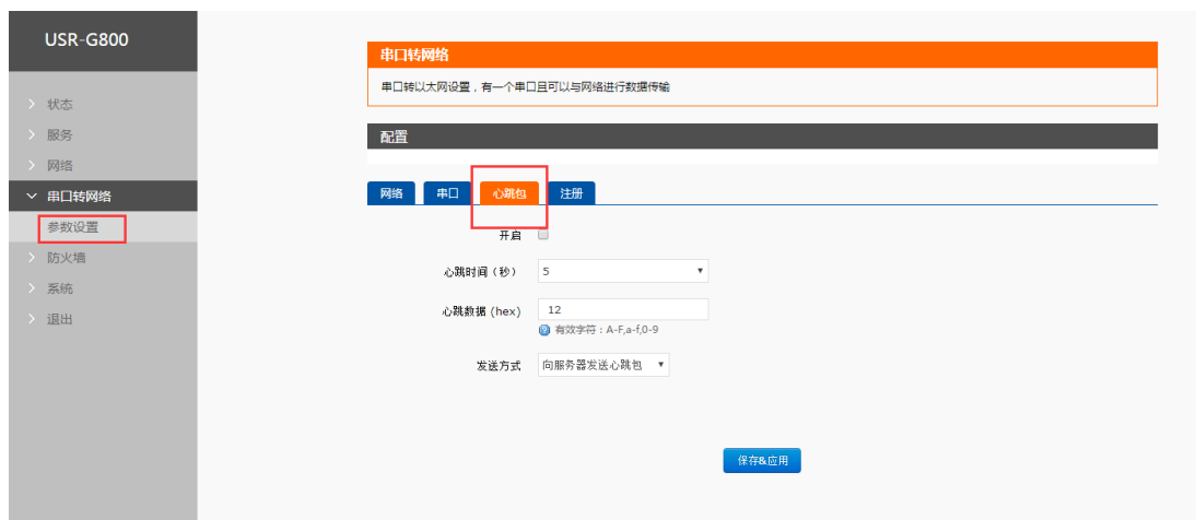
图 54 心跳包参数配置
