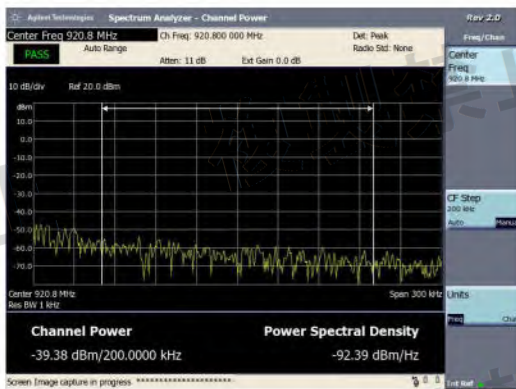
図3.1.3 隣接チャネル漏洩電力 (上側) f_c = 920.6\text{MHz}
