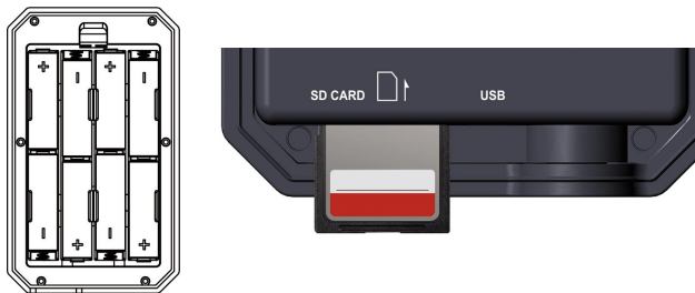
Figura 5: Instalación de baterías y tarjeta SD
