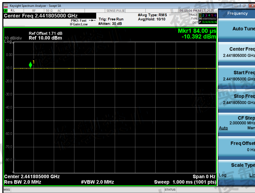
Power NVNT BLE 1M 2442MHz Ant1 Zero Span
