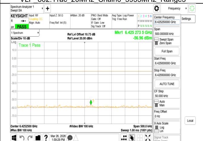
VLP 802.11ac 20MHz Chain0 6175MHz Range2
