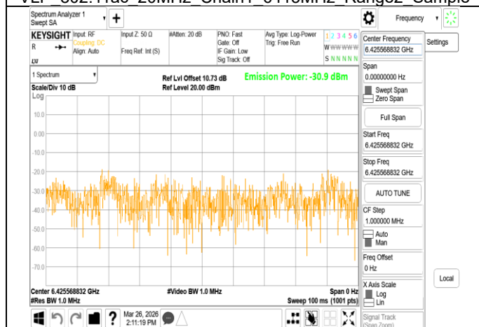
VLP 802.11ac 20MHz Chain1 6415MHz Range3 Sample
