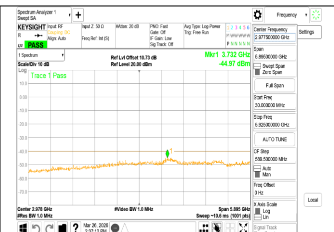
VLP 802.11ac 40MHz Chain1 6405MHz Range1
