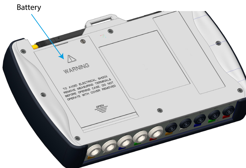
Figure 1: Position de la batterie.
