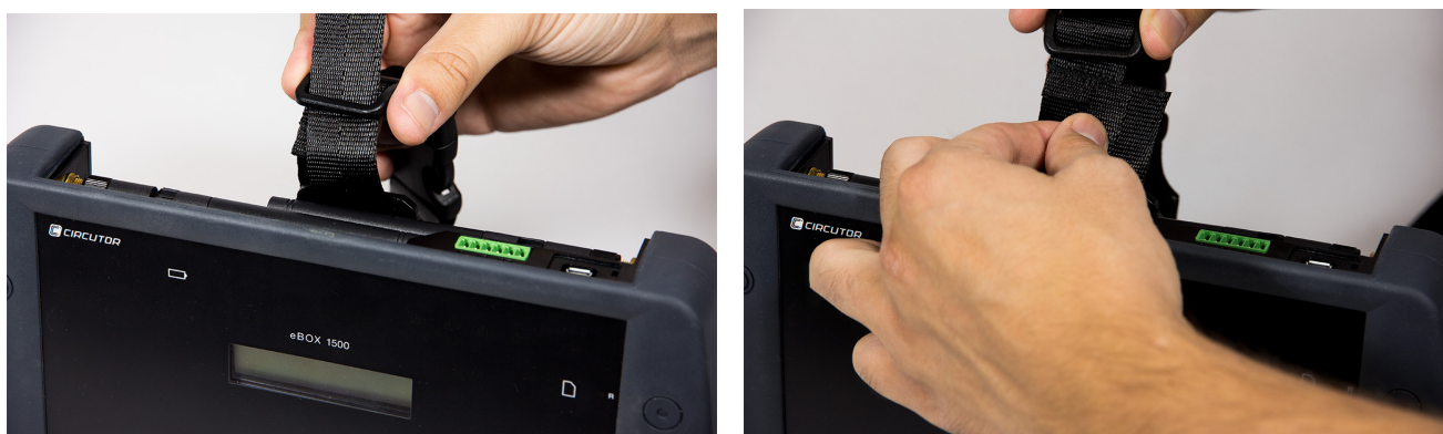
Figure 8: Installation de la courroie de fixation : Étapes 3 et 4.
