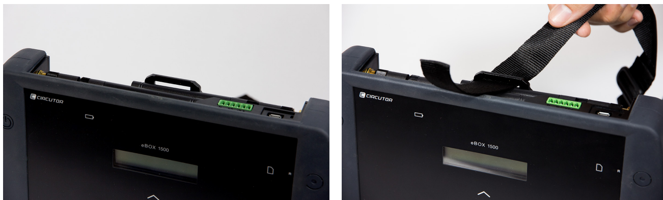
Figure 7: Installation de la courroie de fixation : Étapes 1 et 2.
