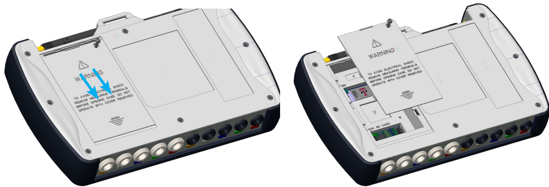
Figure 2: Extraction du couvercle de la batterie.
