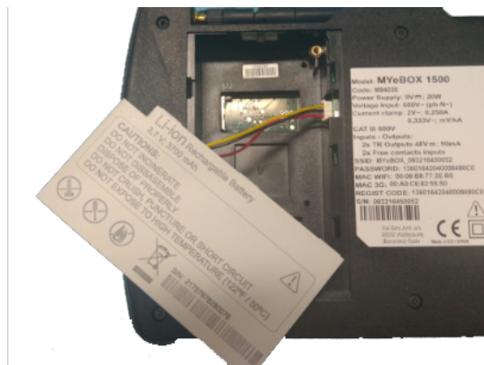
Figure 3: Connectez la batterie.
