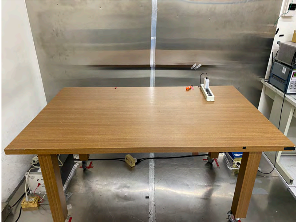
測試照片 傳導干擾量測之配置照片
