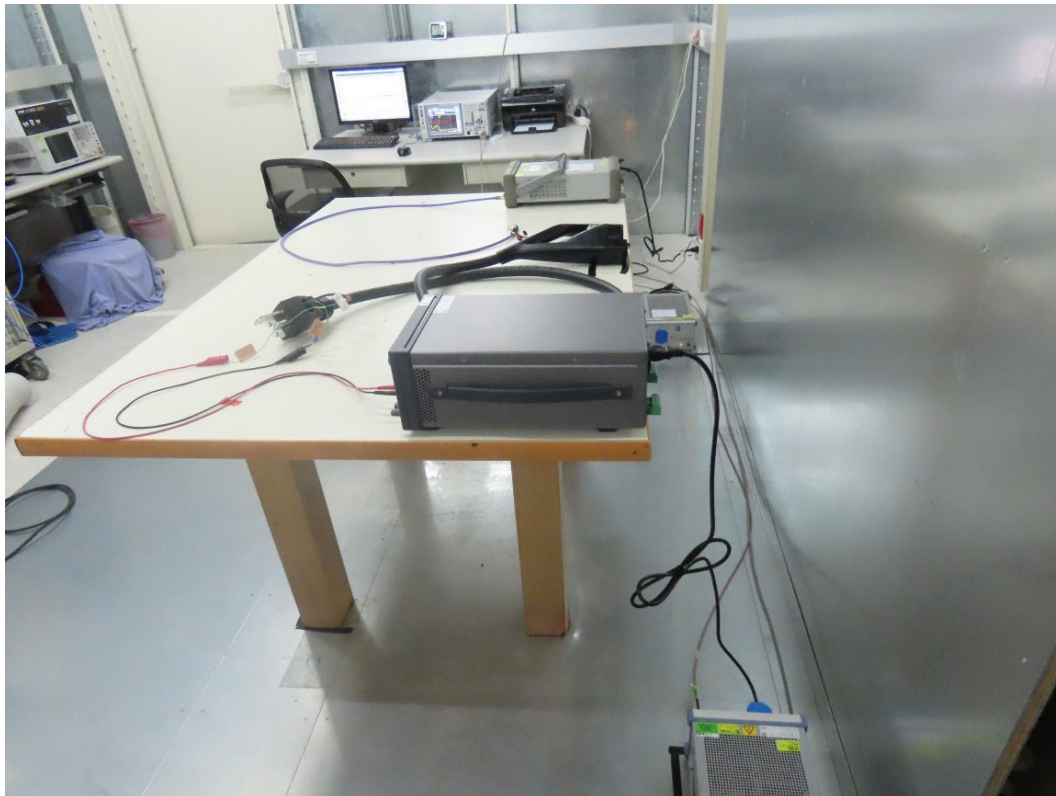
測試相片：電源端點測試 背面相片
