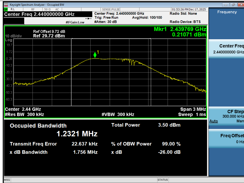
OBW NVNT BLE 1M 2440MHz Ant1
