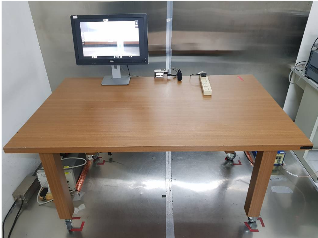
測試照片 傳導干擾量測之配置照片
