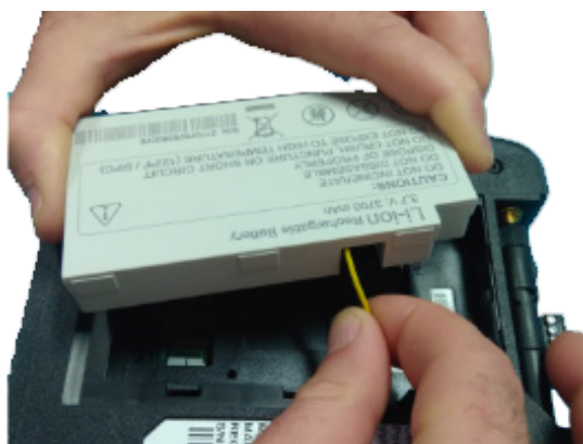
Figura 4: Inserire il cavo di collegamento all'interno del coperchio della batteria.
