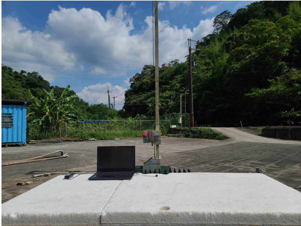
輻射干擾量測之配置照片(1G 以上)
