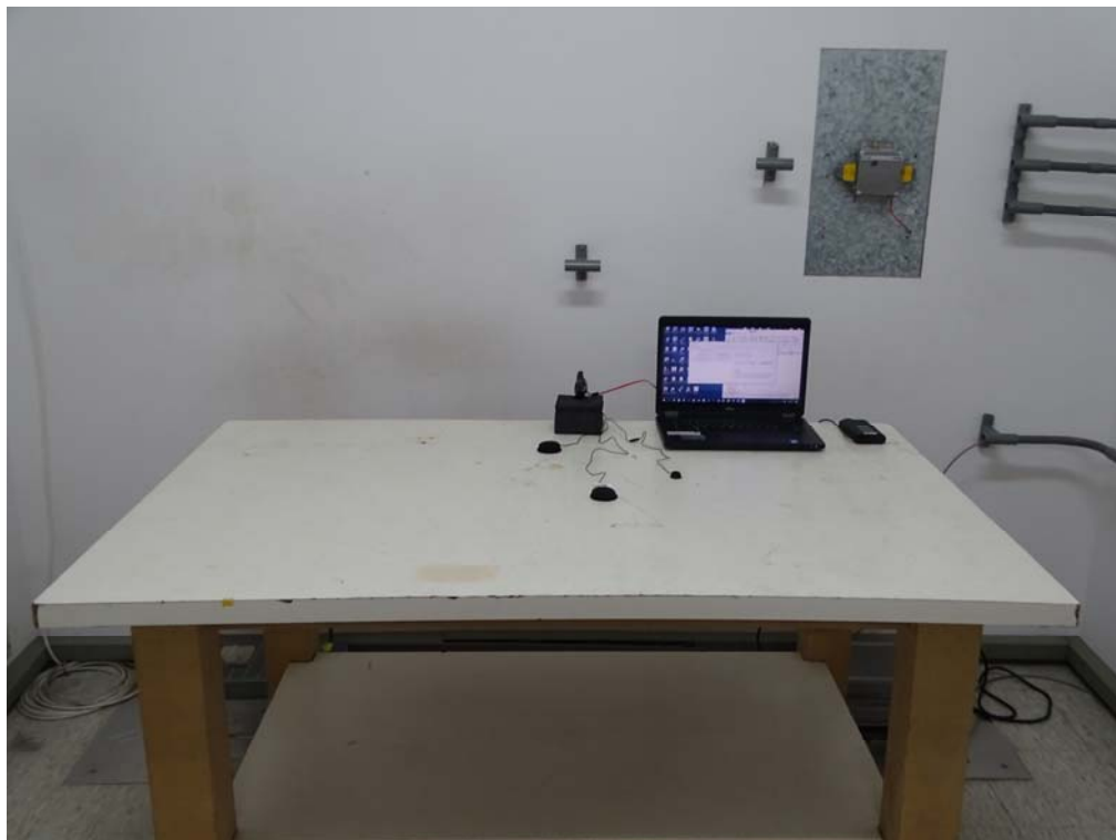
測試相片：電源端點測試 正面相片
