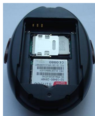
Рис. 7. Сим держатель в закрытом положении
