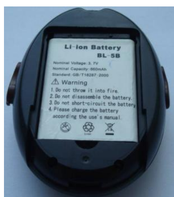
Рис. 8. Аккумуляторная батарея вставлена в трекер
