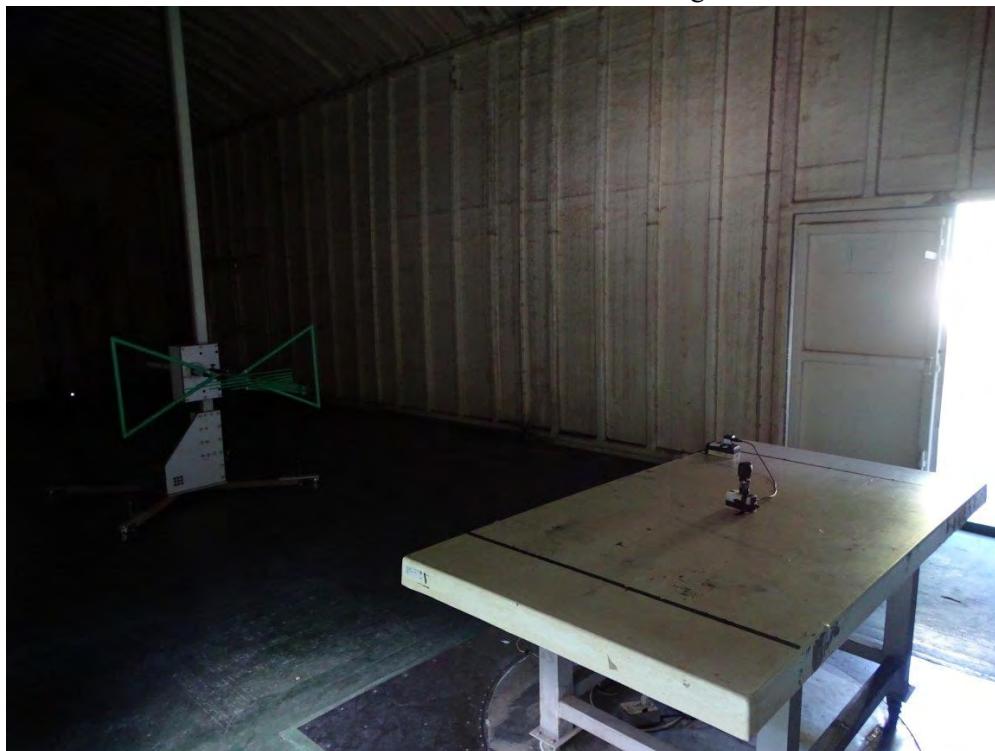
測試相片：輻射測試 正面相片-Charge mode
