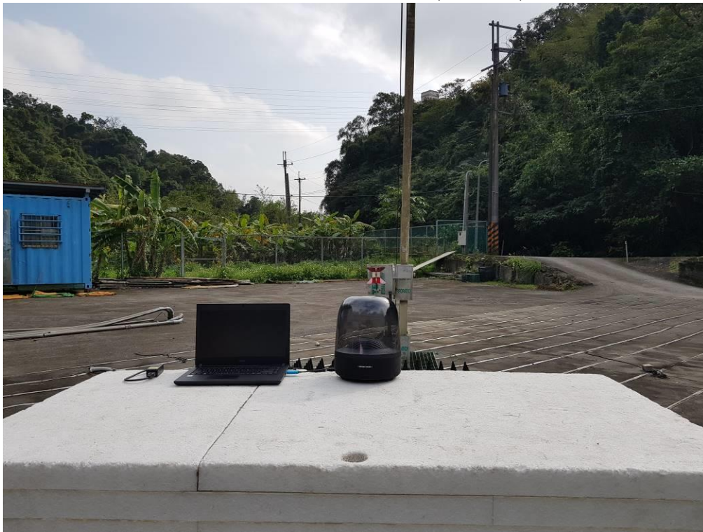
輻射干擾量測之配置照片(1G 以上)
