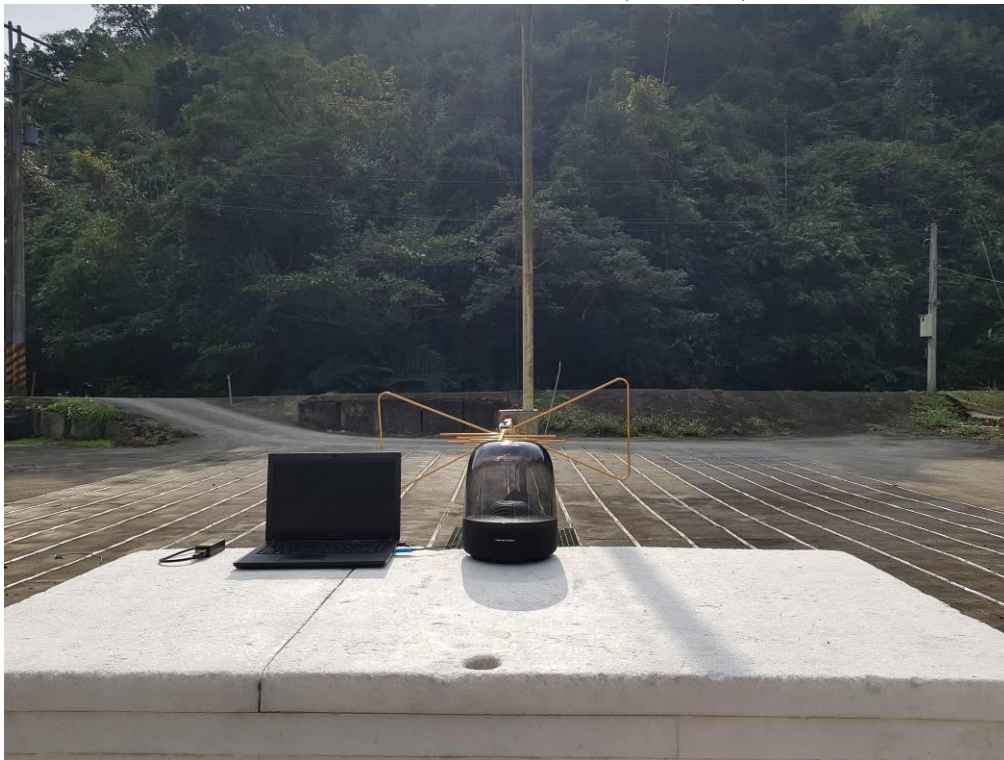
輻射干擾量測之配置照片(1G 以下)
