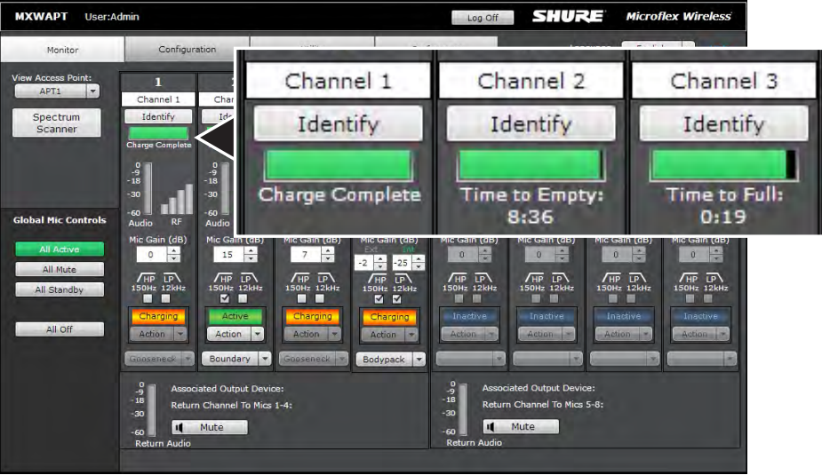
Monitoração do Status da Carga da Bateria
