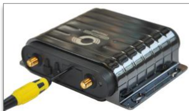
Figura 4. Desatornillando la cubierta pequeña de los MVT600
