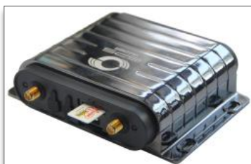
Figura 5. Inserción de la tarjeta SIM en su bahía o puerto.
