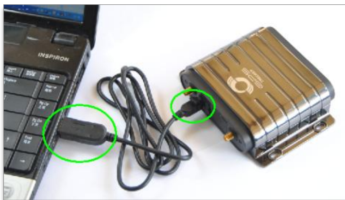
Figura 8. Conexión de rastreadores con PC.
