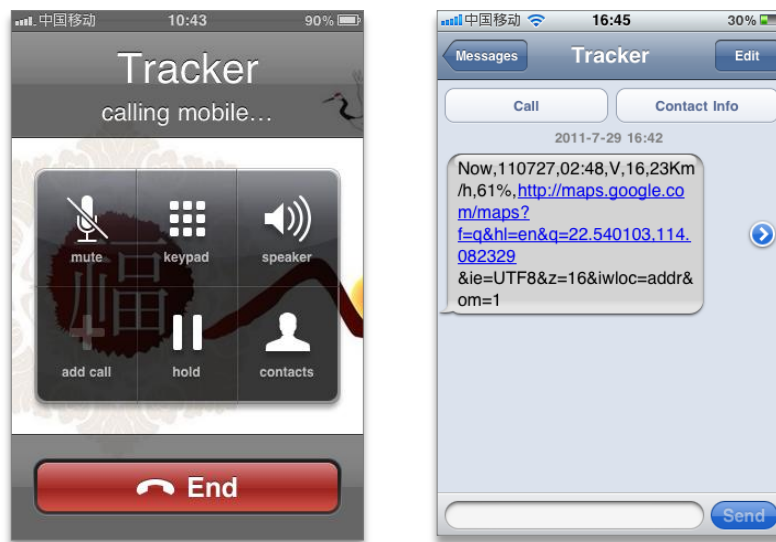
Figura 6. llamada siendo realizada al rastreador por medio de un teléfono móvil y el mensaje de texto enviado por el rastreador conteniendo el enlace de Google Map.
