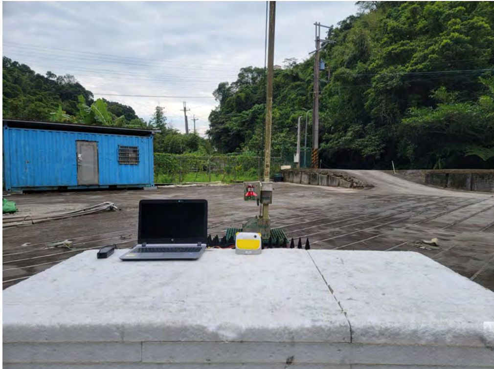
輻射干擾量測之配置照片(1G 以上)
