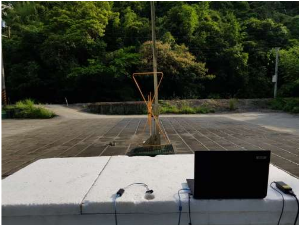
輻射干擾量測之配置照片(1G 以上)
