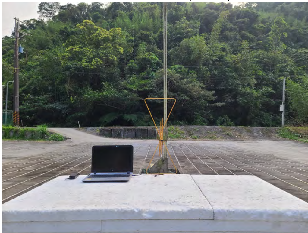
輻射干擾量測之配置照片(1 G 以下)
