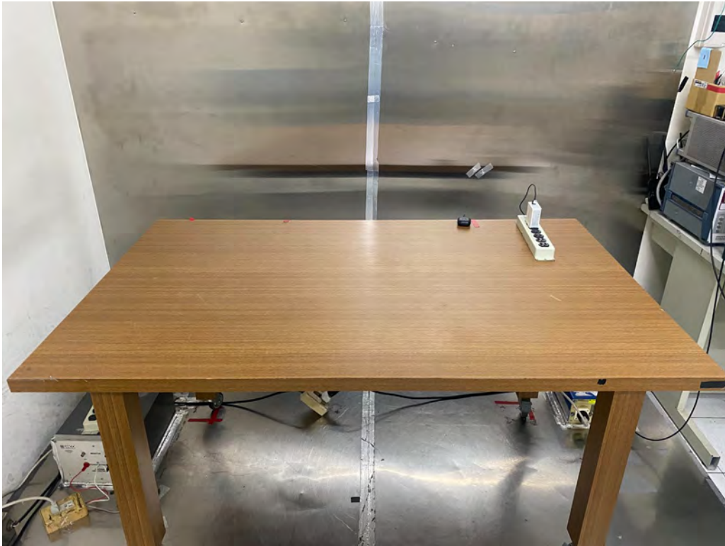
測試照片 傳導干擾量測之配置照片
