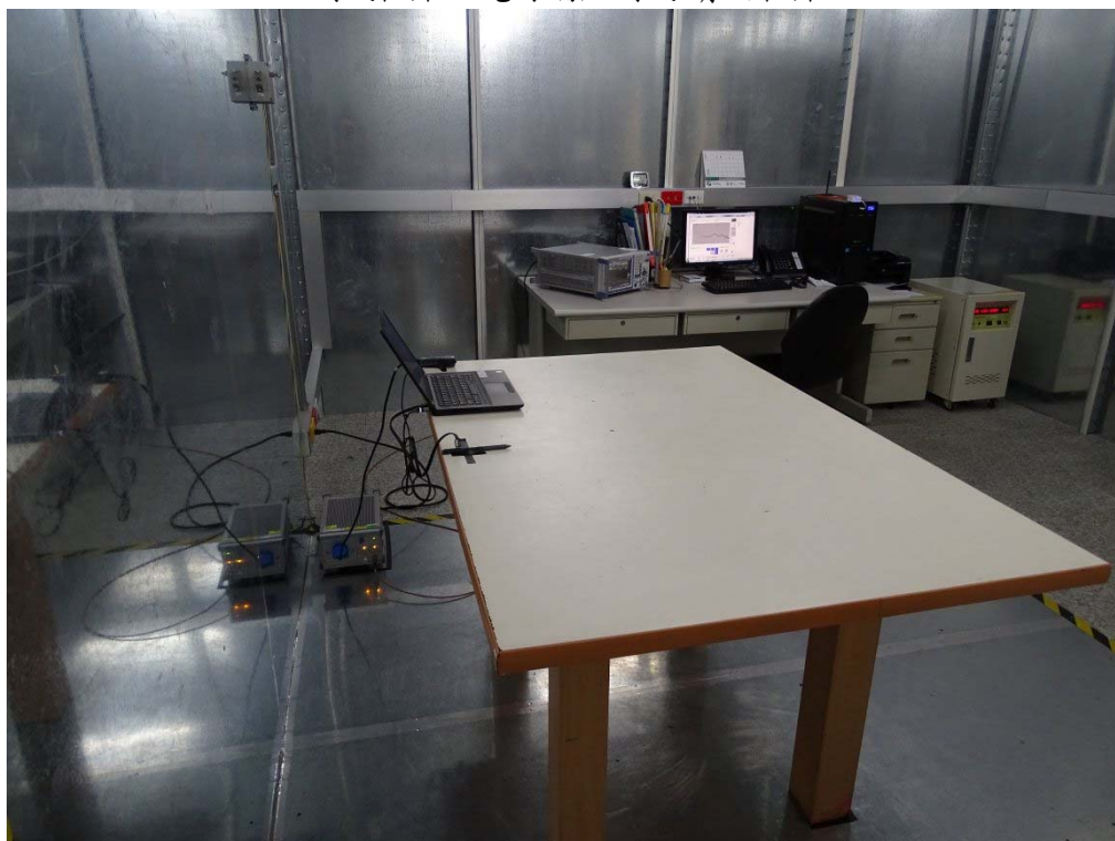
測試相片：電源端點測試 背面相片
