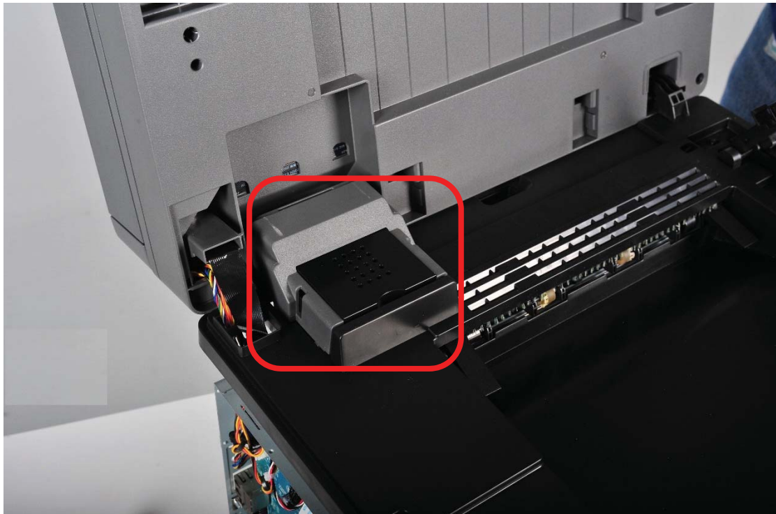
相片 6：特寫照，傳真模組(廠牌:Lexmark, 型號:LEX-M14-002), 位於照片中紅框所標示的掃描器平台下方的位置
