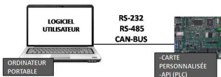
Figure B: exemple de communication sérielle locale
