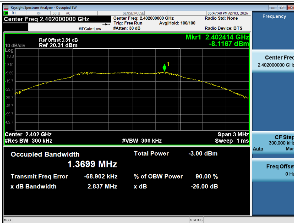
Spreading Bandwidth NVNT BLE 2M 2402MHz Ant1
