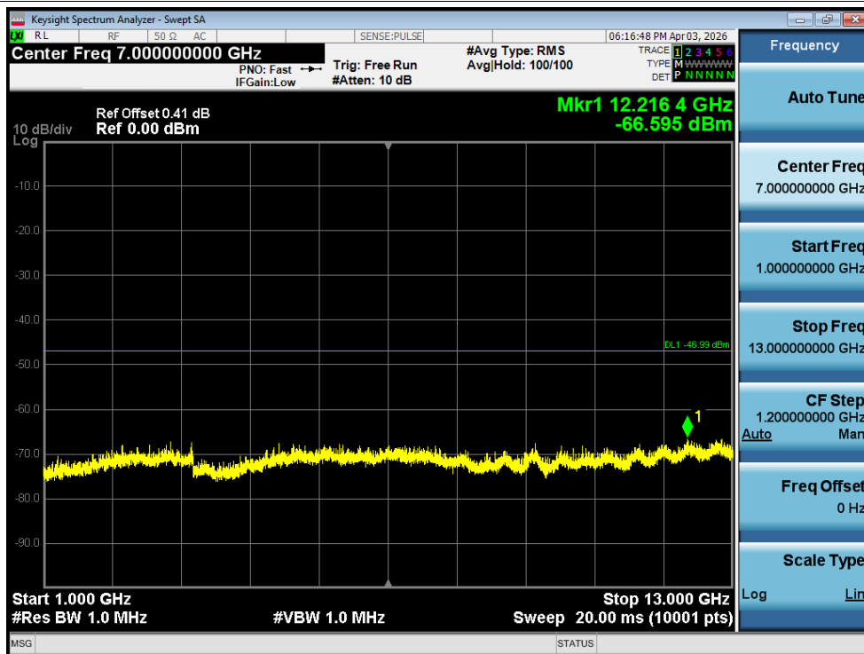
Rx. Spurious NVNT BLE 2M 2480MHz Ant1 @ 1000MHz-13000MHz
