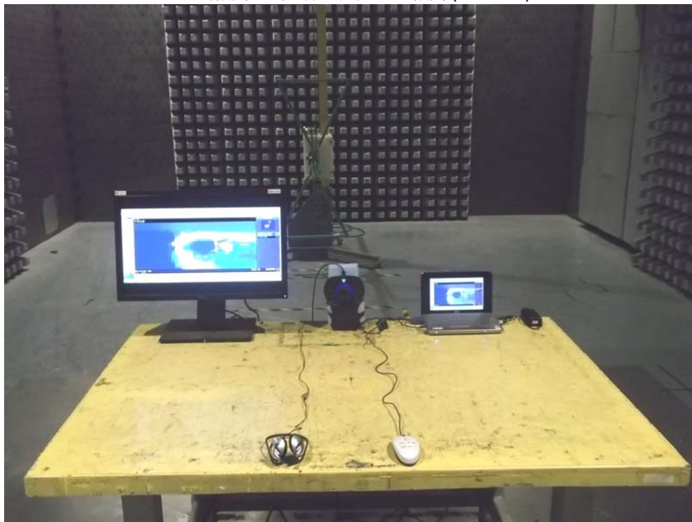
測試相片：輻射測試 正面相片 (Mode 1)
