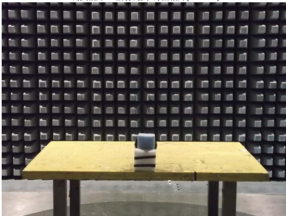
測試相片：輻射測試 背面相片 (Mode 2)
