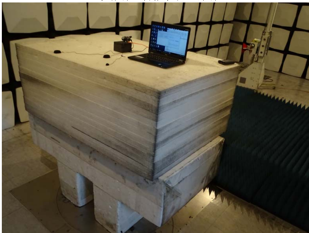
測試相片：輻射測試 正面相片
