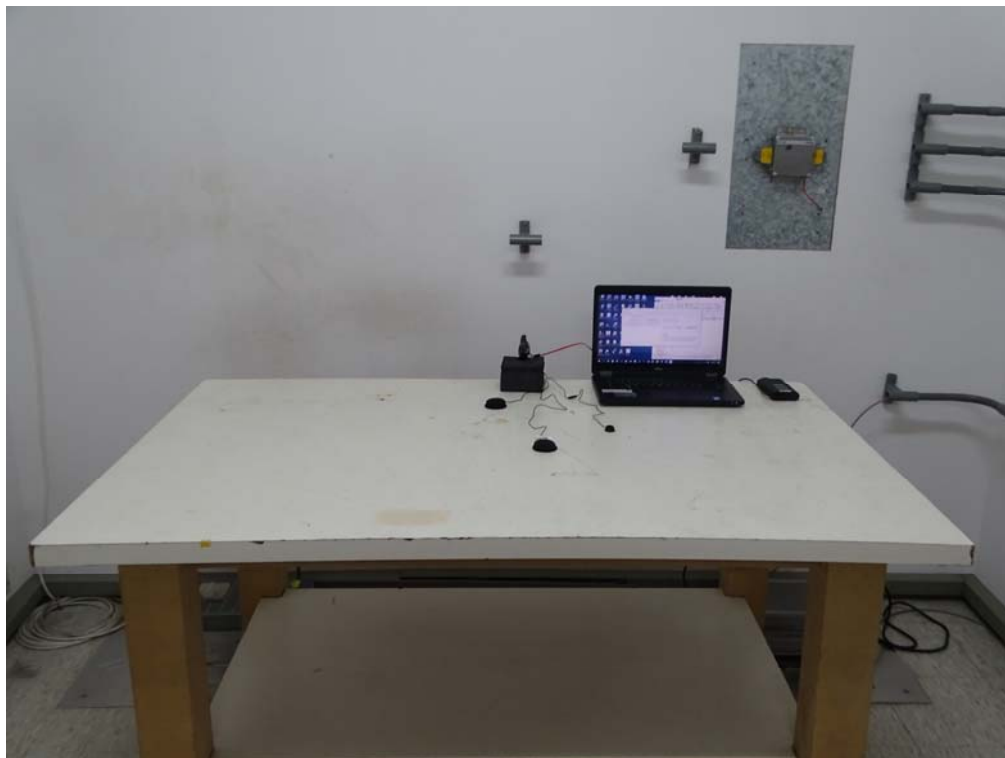
測試相片：電源端點測試 正面相片
