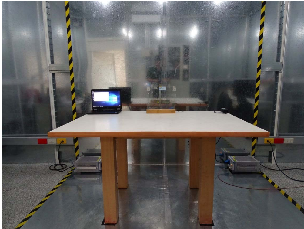
測試相片：電源端點測試 正面相片
