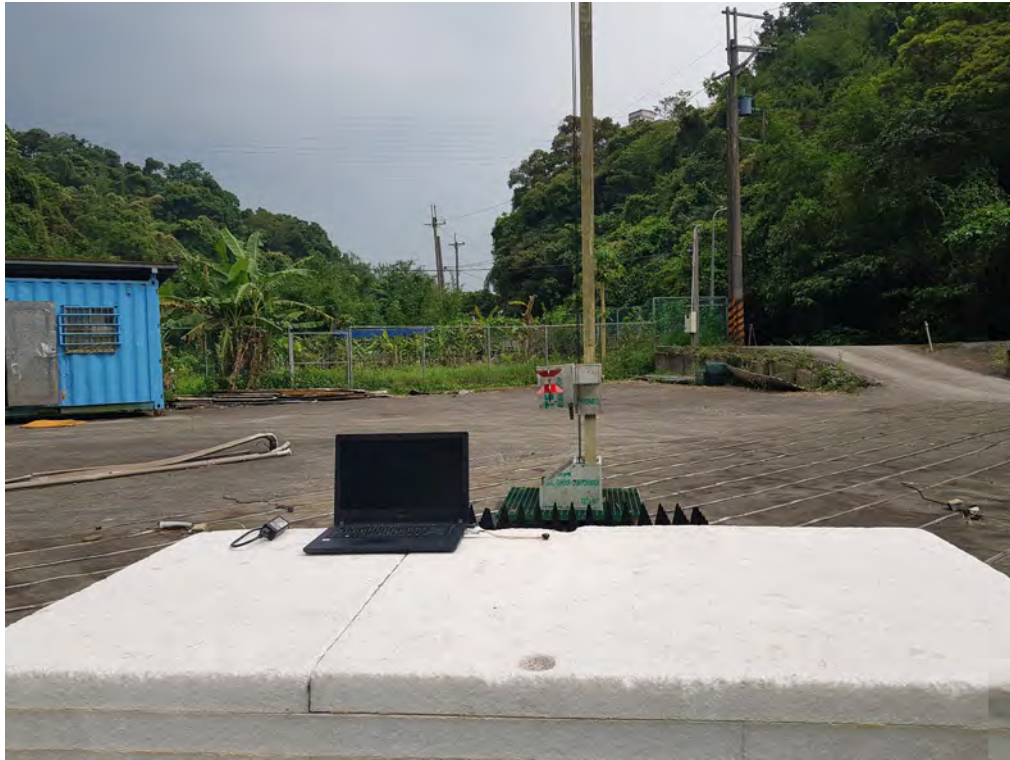
輻射干擾量測之配置照片(1G 以上)
