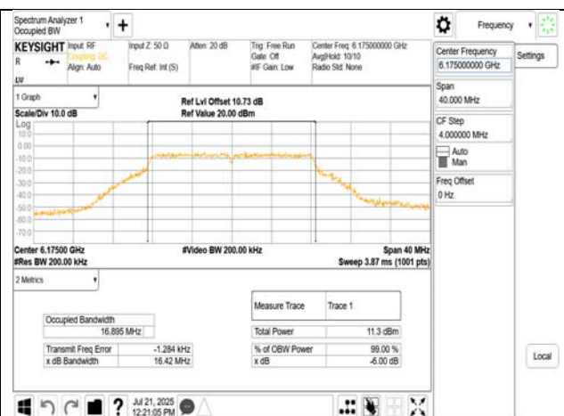
LPI 802.11a 20MHz Chain0 6175MHz
