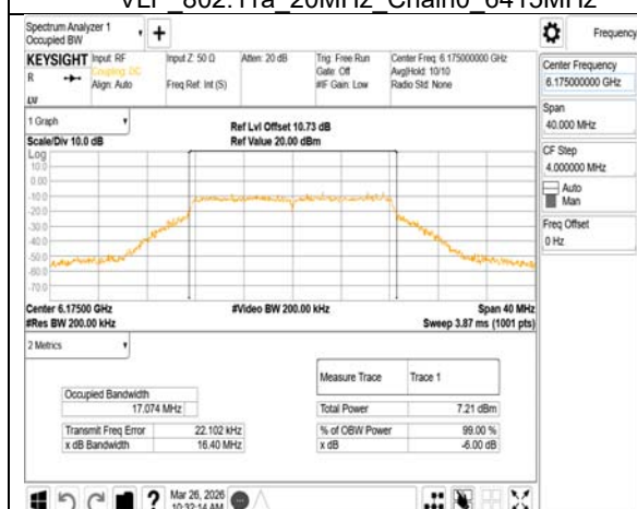
VLP 802.11a 20MHz Chain1 6175MHz
