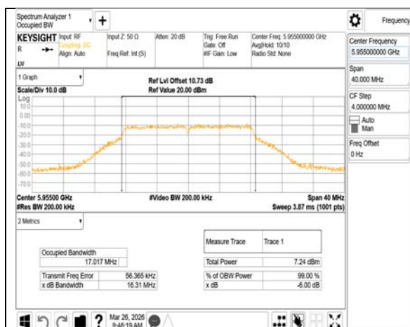
VLP 802.11a 20MHz Chain0 5955MHz
