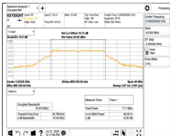
LPI 802.11a 20MHz Chain0 5955MHz
