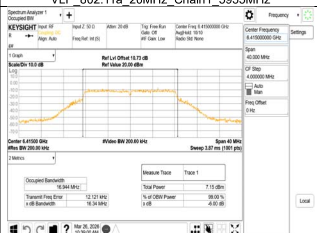
VLP 802.11a 20MHz Chain1 6415MHz
