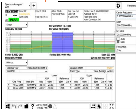
LPI 802.11n 40MHz Chain0 5965MHz
