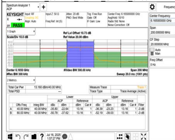
LPI 802.11n 40MHz Chain1 6165MHz
