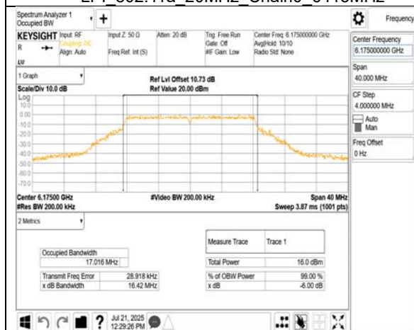
LPI 802.11a 20MHz Chain1 6175MHz
