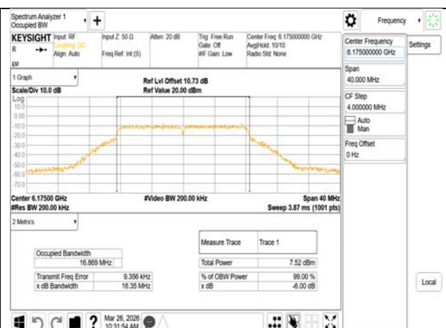
VLP 802.11a 20MHz Chain0 6175MHz
