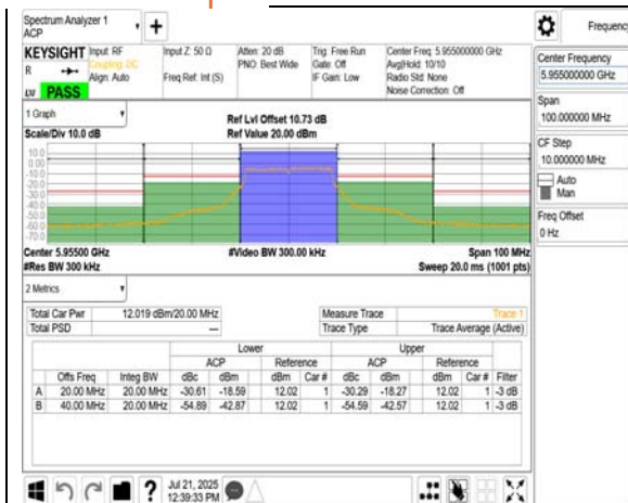
LPI 802.11n 20MHz Chain1 5955MHz
