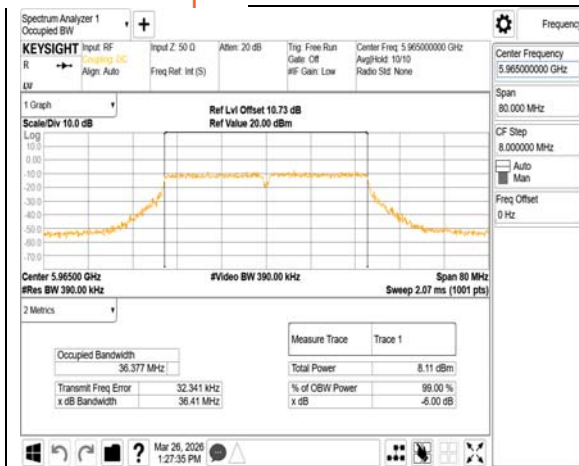
VLP 802.11n 40MHz Chain0 5965MHz
