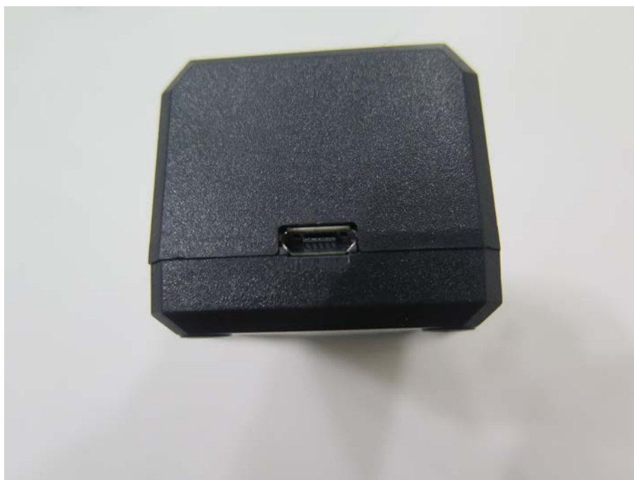
充電座 I/O Port 照
