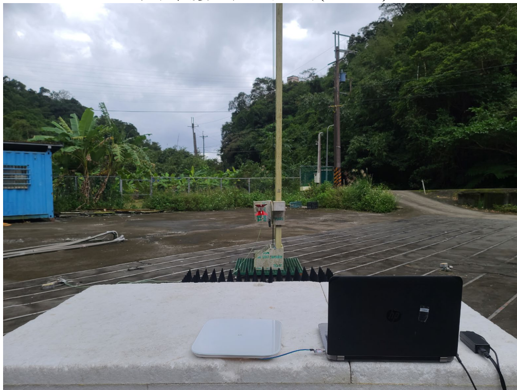
輻射干擾量測之配置照片(1G 以上)
