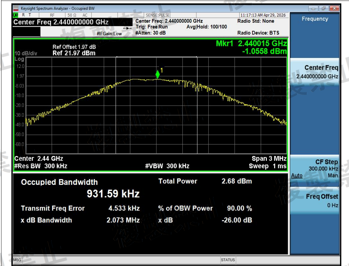
Spreading Bandwidth NVNT BLE 1M 2440MHz Ant1
