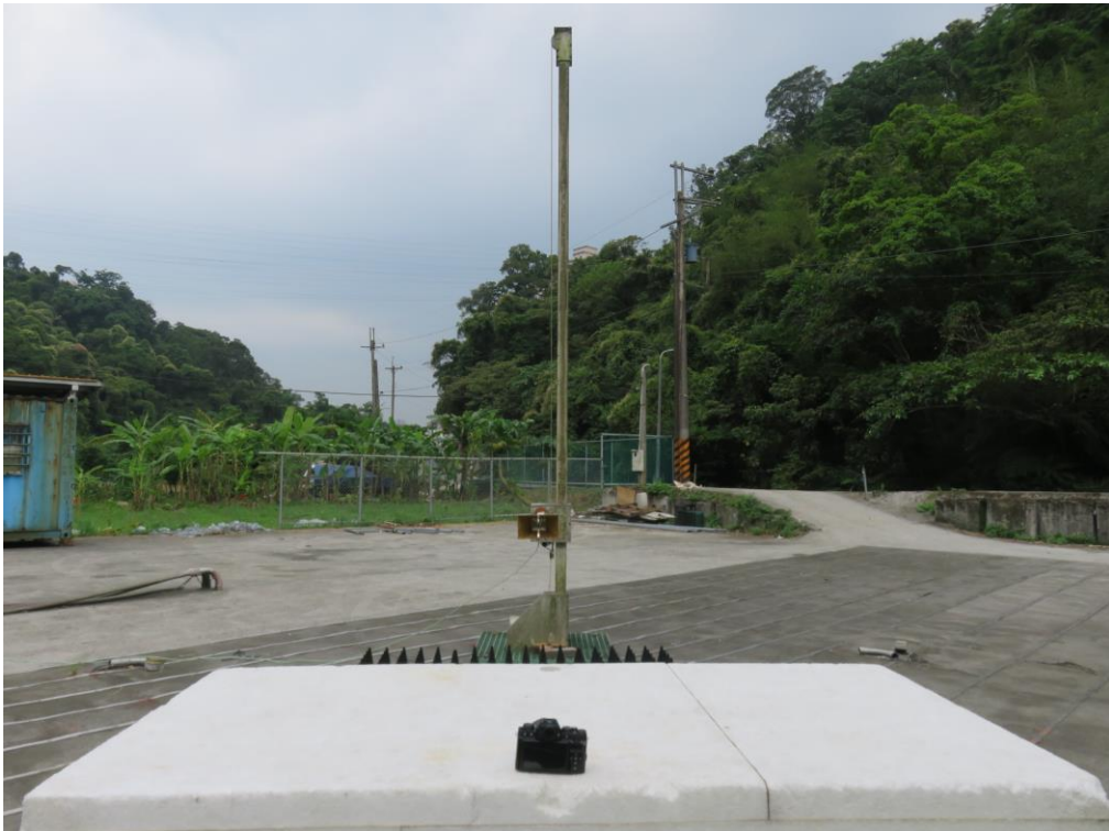
輻射干擾量測之配置照片(1G 以上)
