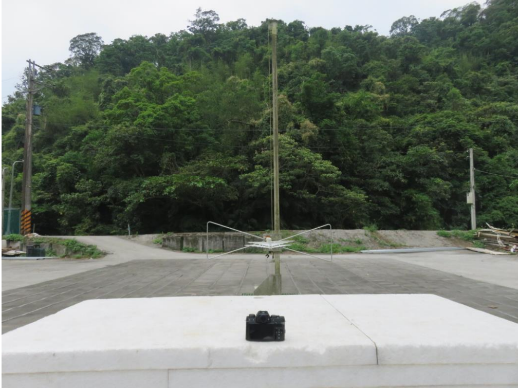
輻射干擾量測之配置照片(1G 以上)
